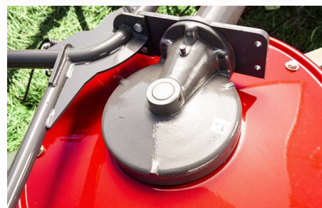
Les joints à double croix de faible entretien, l'accès facile aux raccords de graissage des pivots, la boîte d'engrenages remplie d'huile donnent lieu à un faible coût d'exploitation et facilite l'entretien.
