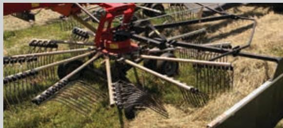
**LES LONGUES DENTS** à surface avant lisse permettent une durée de vie prolongée, un dé-gagement en douceur de la culture et la création d'un andain propre et uniforme. Le design des dents permet de les remplacer individuellement et facilite l'entretien.
