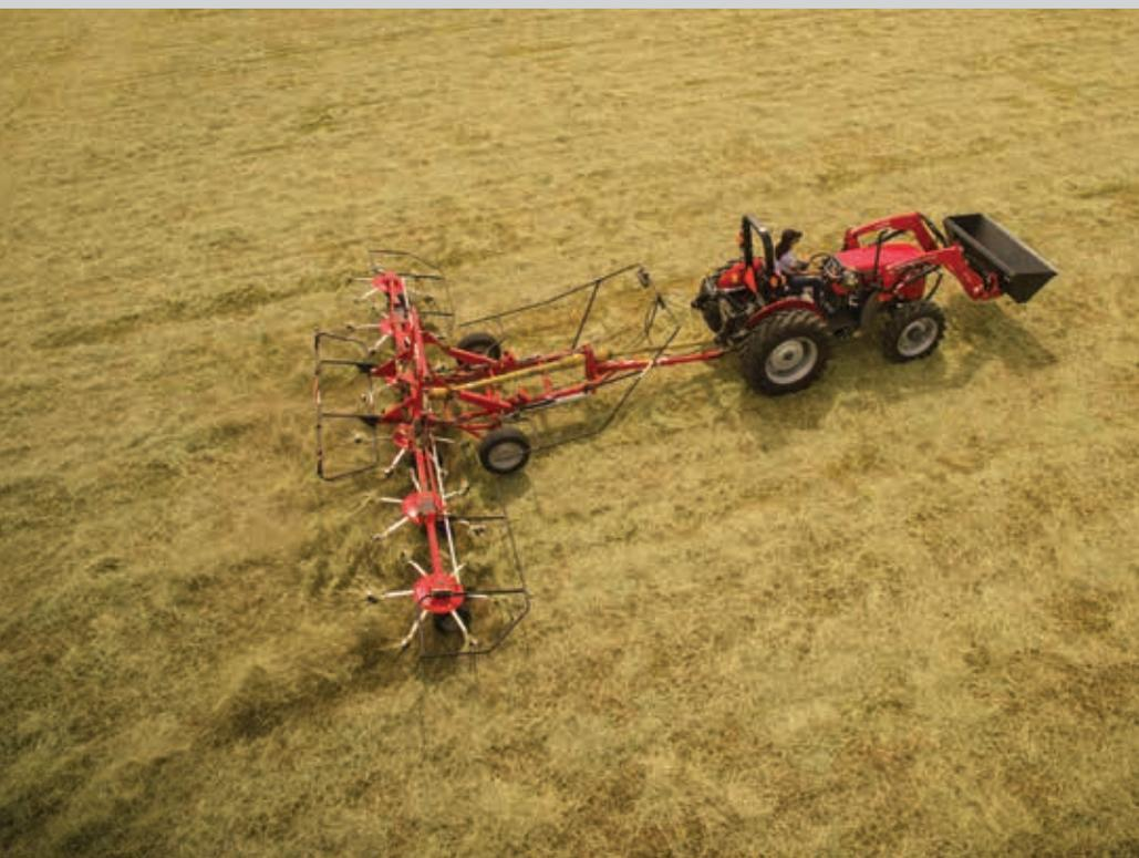
Tous les modèles sont simples à préparer et à régler pour couvrir avec efficacité plus de terrain. Les modèles à quatre, six, huit et dix toupies comportent aussi un relevage synchronisé des toupies extérieures par un système hydraulique central et des cylindres de pression. Le tout assure une performance optimale et élimine les surcharges d'un seul côté, même sur les pentes.
