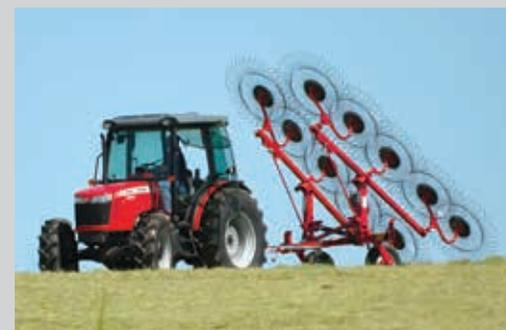
**UN CYLINDRE À SIMPLE EFFET** referme les deux ailes pour faciliter le déplacement hors champ (offert sur les modèles 1508, 1510 et 1512).
