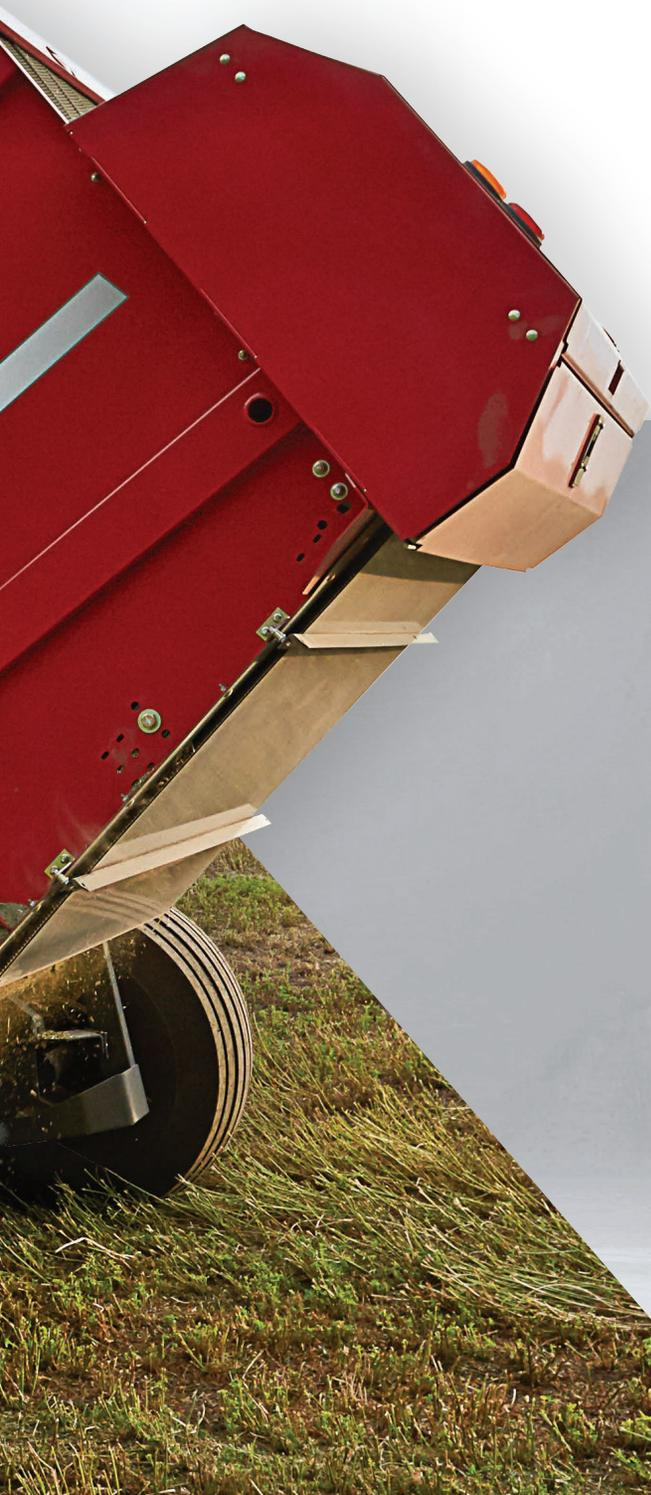
Notre système unique *Quad Cylinder System* (QCS) optimise la densité des balles en fonction de vos conditions. Il garantit que les courroies suivent bien la trajectoire lorsque vous actionnez la porte arrière. Un éjecteur hydraulique simplifié éjecte la balle en douceur et la dépose là où vous le souhaitez. Vous pouvez aussi opter pour une rampe à ressort, si cela convient mieux à votre activité.
