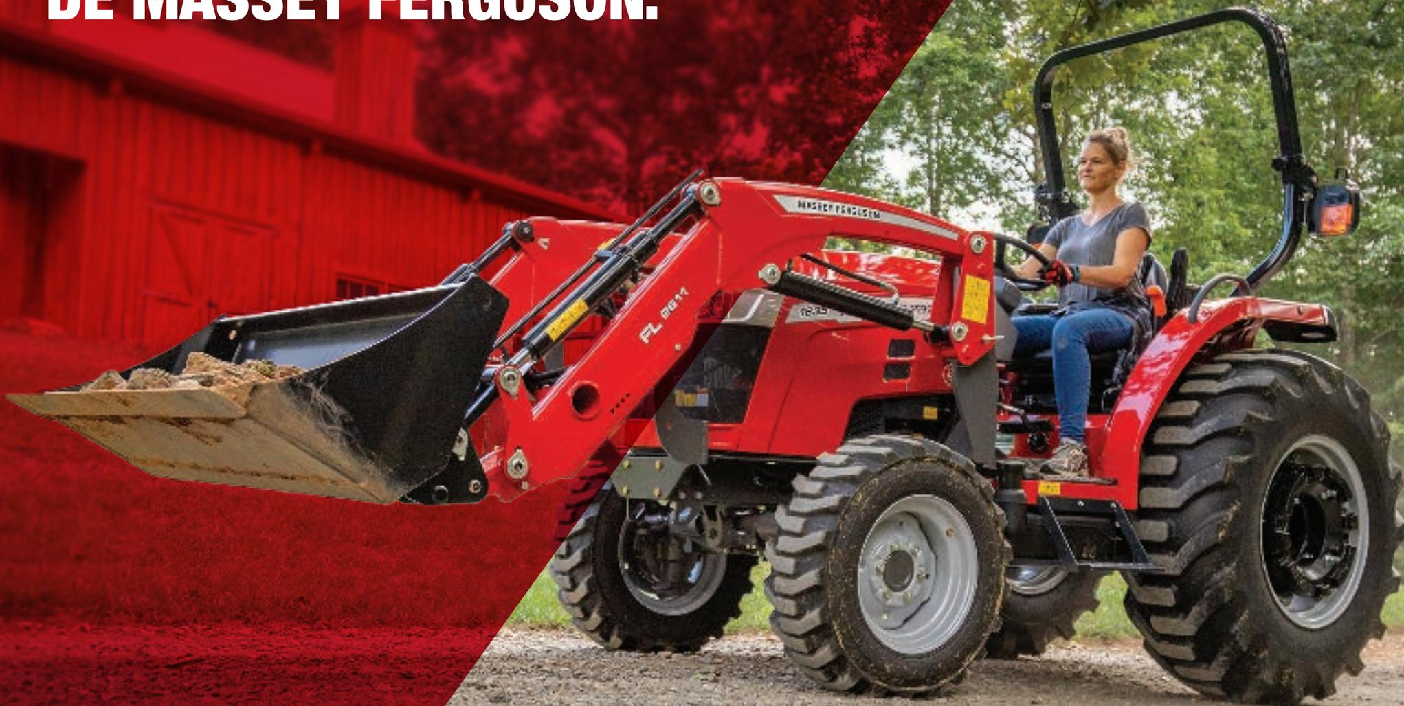
**À COMMENCER PAR LE CHARGEUR DE LA SÉRIE L** — Deux choix de godets s'offrent à vous : 66 ou 72 pouces de large. Le coupleur à glissement standard permet de retirer ou d'accrocher facilement le godet. Ajoutez un troisième auxiliaire et bénéficiez de la polyvalence d'autres accessoires courants avec coupleur à glissement comme un grappin ou un godet 4 en 1.
