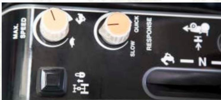
**LE RÉGULATEUR DE VITESSE ACCOMPAGNE DE SÉRIE** la transmission hydrostatique. Réglez simplement la vitesse de travail désirée, engagez et démarrez. L'appui sur la pédale de frein ou sur la pédale de marche avant désengage le système.
