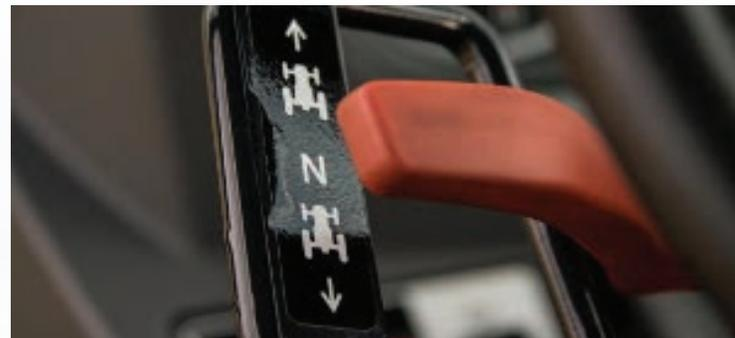
**PLACÉ SUR LA COLONNE DE DIRECTION,** le levier de l'inverseur change la direction rapidement et facilement. C'est idéal pour le travail avec le chargeur.
