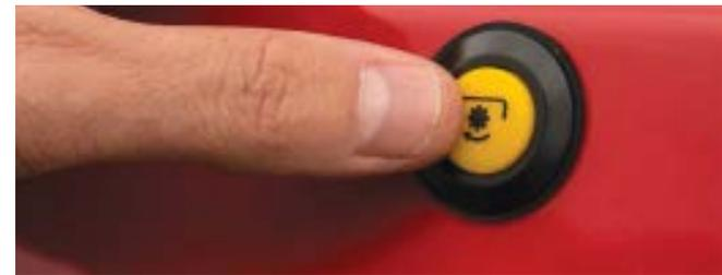
**L'INTERRUPTEUR DE PDF FIXÉ À L'ARRIÈRE FACILITE** sa mise en marche et son arrêt. Une fonction très pratique lorsque vous utilisez une tarière, une fendeuse à bois ou un générateur.
