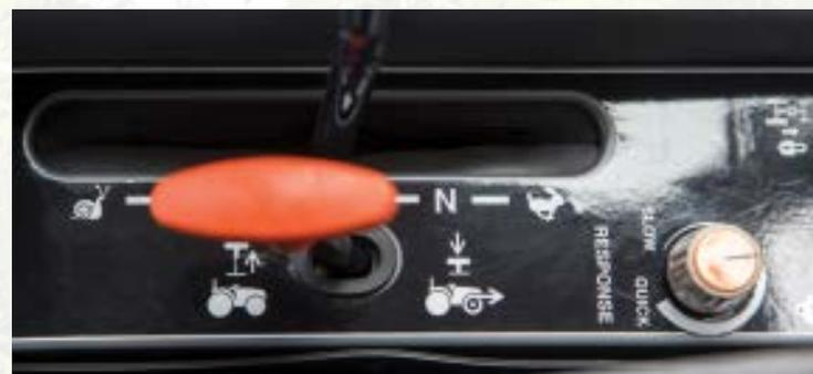
**AJOUTEZ À LA TRACTION** pour les travaux et les conditions difficiles grâce aux quatre roues motrices sur demande. Poussez simplement le levier vers le bas pour l'engager. Tirez-le vers le haut pour le désengager.
