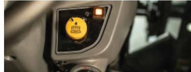
**LA PDF ARRIÈRE (540 TOURS/MIN) DE SÉRIE ET LA PDF VENTRALE (2 000 TOURS/MIN) EN OPTION SONT À COMMANDE ÉLECTROHYDRAULIQUE. CELA PERMET UNE PLUS GRANDE DOUCEUR ET UNE MISE EN MARCHÉ** sans claquement désagréable. La modulation *SoftStart* réduit les secousses brusques, diminue l'usure et minimise les temps d'arrêt imprévus.
